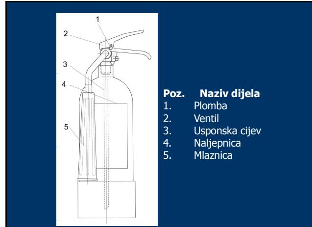
Prijevozni aparati za gašenje požara ugljičnim dioksidom proizvode se u Hrvatskoj u veličinama od 10, 30 i 60 kg. Namijenjeni su za gašenje požara uređaja pod naponom električne struje, a mogu se upotrijebiti za gašenje požara razreda B i C. Ovi aparati pune se s 10% manjom količinom plina od nazivne vrijednosti.
